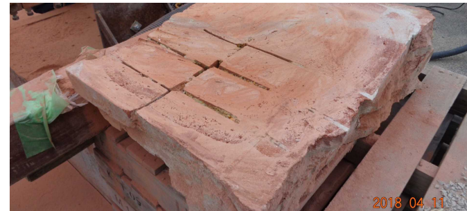
煙突煉瓦構造体を用いた切断試験
